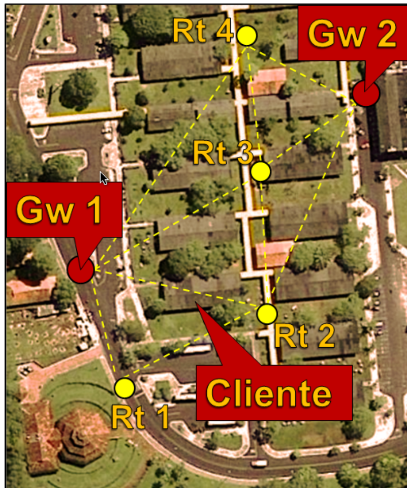
Figura 17: Composição do Backbone da rede em malha sem fio da UFPA.
